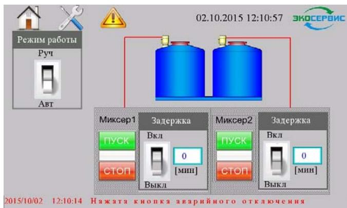
Рис.9.7. Установка времени отключения мешалок
