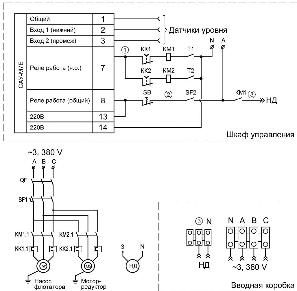
Рис. 3. Принципиальная электрическая схема флотатора.
