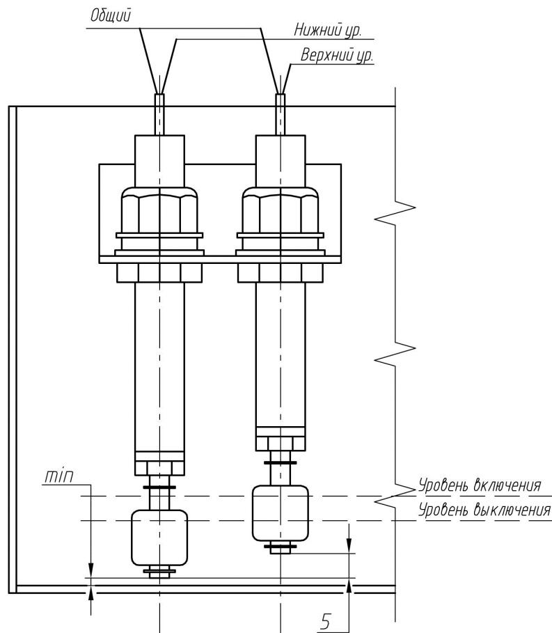
**Рис. 3. Общий вид датчика уровней.**
